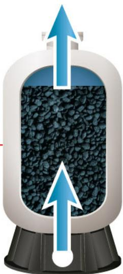
6. Retrolavar el filtro con la velocidad de diseño del equipo, hasta que el agua del retrolavado esté clara.
